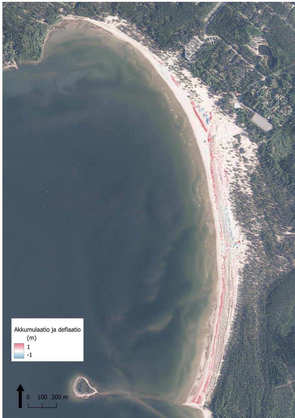
Kuva 1. Hiekan akkumulaatio- ja deflaatioalueet Yyterin santojen alueella vuosien 2022 ja 2025 välillä. Hiekkaa on kerääntynyt lisää rannan keski- ja eteläosiin. Deflaatiota on ilmennyt lähinnä Lomakeskuksen kulkureitin yhteydessä sekä vaurioituneella dyynillä rannan keskiosan uimarannalla.
